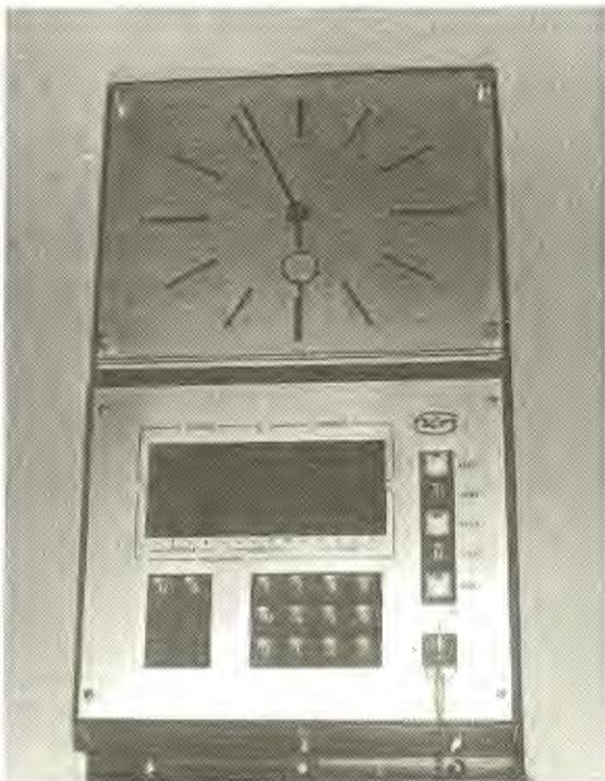
Die von der Turmuhrfabrik Hörz in Ulm installierte elektronische Digital-Hauptuhr mit der Programmierereinrichtung.
