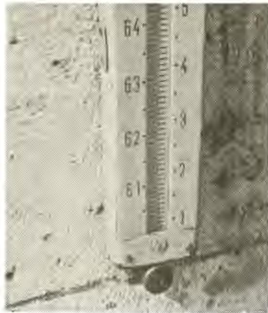
Mauerbolzen mit aufgesetzter Nivellierlatte
